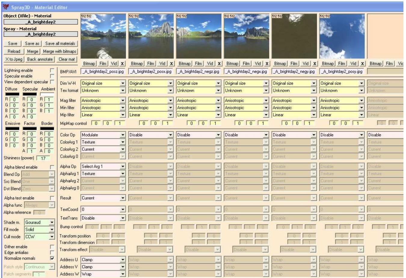
Questi materiali vengono inizializzati in modo particolare con sei textures visibili e con "AddressU" e "AddressV" impostati a "Clamp" per evitare le righe di giunzione tra le immagini.
